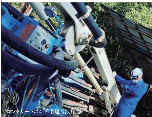
超音波探傷検査(材料・鍛鋼品検査)
